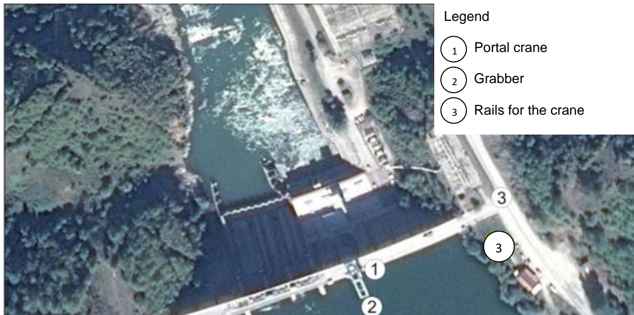
Slika 38 Postavljena oprema za hvatanje plutajućeg otpada u Potpečkom jezeru (Lim)
